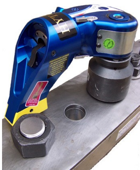
Clé HY 3 MXT EN POSITION DE SERRAGE
