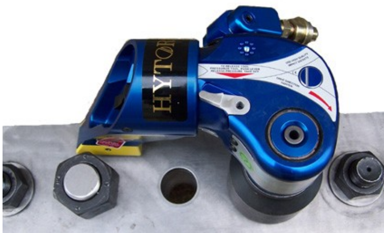
Clé HY 3 MXT EN POSITION DE SERRAGE
