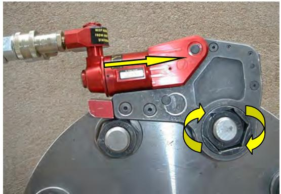
Lorsqu'on maintient le bouton "A" de la commande à distance appuyé, le piston avance, l'écrou tourne, la pompe monte en pression quand le vérin est en fin de course.
