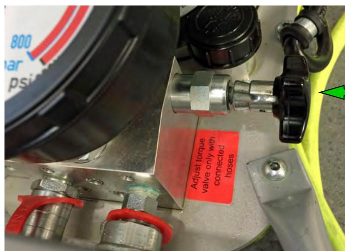
Le régulateur de pression se situe sur le côté droit du distributeur du groupe moto pompe , à côté du manomètre de pression.
