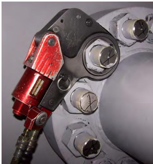
**PROBLEME:** La clé reste sous tension . Le serrage est terminé et l'on ne peut pas retirer la clé de l'écrou. La clé hydraulique est bloquée.
