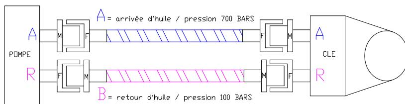
Le montage d'un nombre de flexibles pair est impossible pour le bon fonctionnement de l'ensemble de serrage. Ce montage inverse le flux hydraulique.
