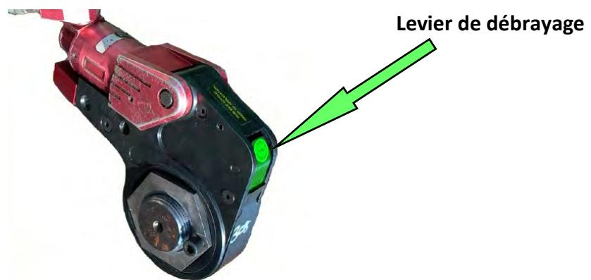
**SOLUTION:** Remonter en pression en actionnant Le bouton A (bouton vert sur commande à distance) ; maintenez appuyé et libérez la clé en appuyant sur le levier de débrayage situé à l'arrière de la clé XLCT . (voir photo)
