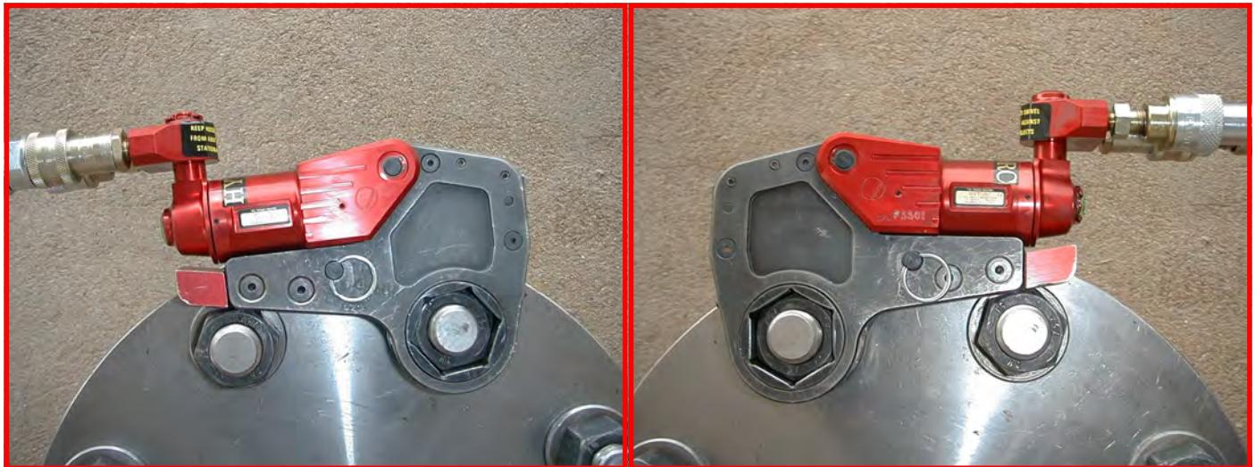
La réaction de la clé est absorbée par le talon de la cartouche à oeil lorsque l'entraxe avec l'écrou voisin le permet.
