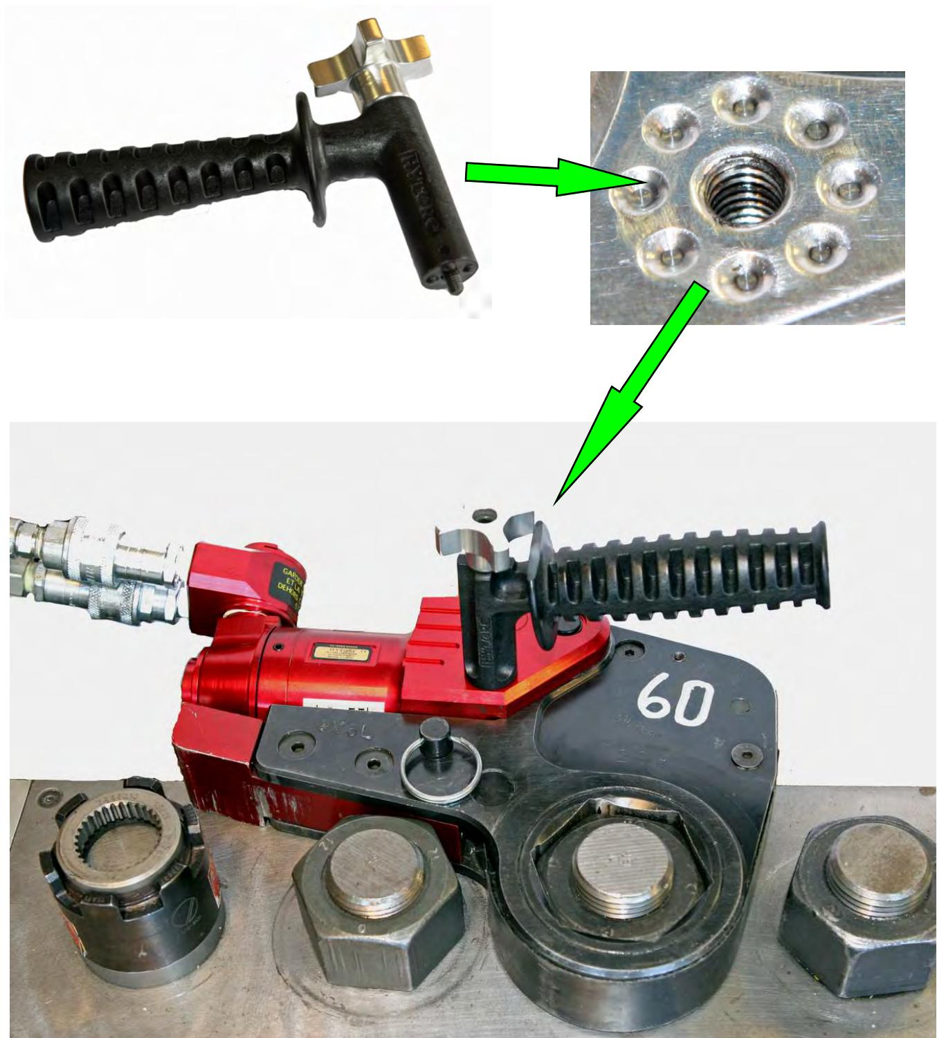
**A chaque arrêt du groupe moto pompe, un système automatique permet de d'annuler la pression résiduelle restante dans les des flexibles jumelés avant démontage des coupleurs hydrauliques. Toutefois si vous rencontrez des difficultés à desserrer les coupleurs vissées , il est conseillée d'actionner la valve solenoid en exerçant une pression à son extrémité.**
