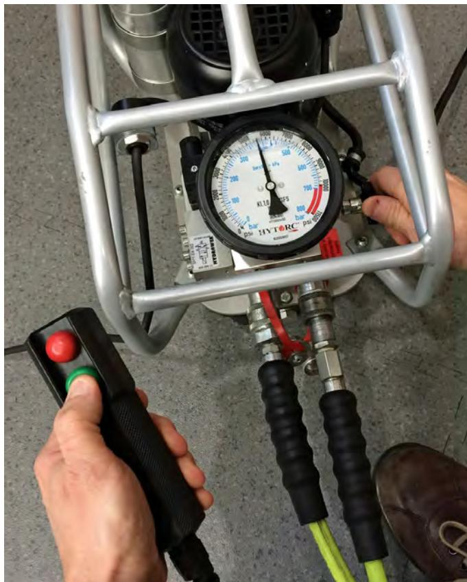
**Etape 1:** Vérifiez le type de clé utilisée , le tableau de conversion pression couple doit correspondre au type de clé utilisée.
