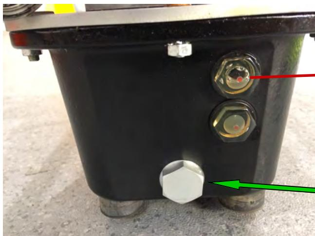
Le niveau d'huile HV 32 doit toujours se situer au milieu du deuxième indicateur de niveau d'huile (le plus haut sur le réservoir)
