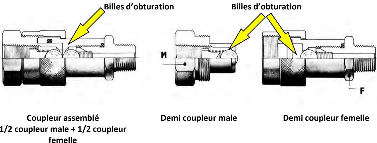
Les coupleurs vissés PIONEER 3000 - 2 doivent être assemblés de manière à ce que les billes d'obturation libèrent le passage du fluide hydraulique.
