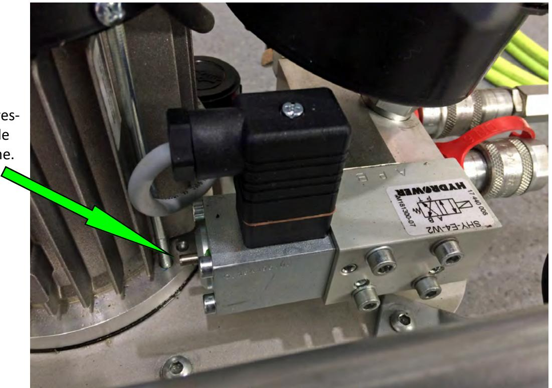
Pour faciliter le démontage des coupleurs hydrauliques, il est nécessaire sur les pompes de type HYTORC JETPRO de décompresser les flexibles en effectuant une pression sur l'extrémité de la bobine valve solenoid. Voir photo.
