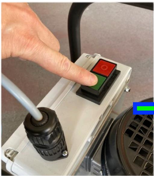
Appuyer sur l'interrupteur de couleur verte situé sur le boîtier électronique du groupe hydraulique .L'interrupteur doit resté enfoncé.
