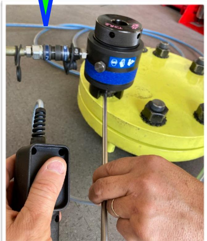
**Relâcher la pression en basculant le levier de la vanne principale vers la gauche . La pression reviendra à Zéro .**
