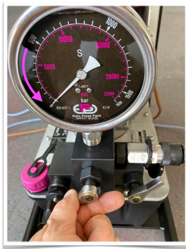
**Une fois que la pression est relâchée et indique Zéro sur le manomètre , vous pouvez désengager le vérin de la boulonnerie.**
