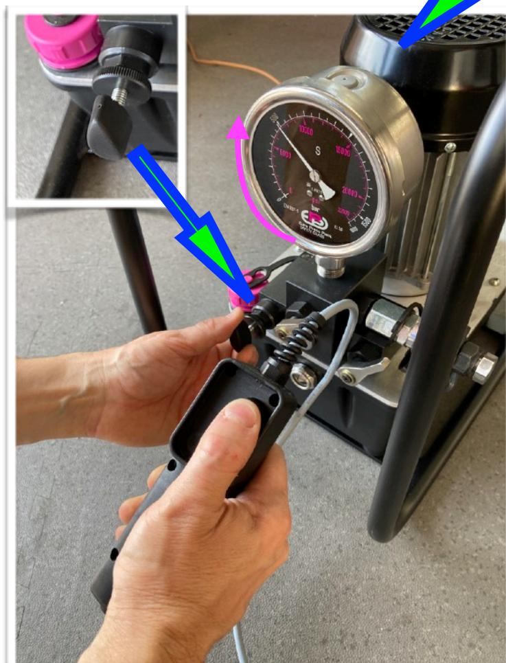
Appuyer sur le bouton blanc de la commande à distance , rester appuyé , puis tourner la vis molletée du régulateur de pression dans le sens horaire pour augmenter la pression jusqu'à atteindre la pression souhaitée.
