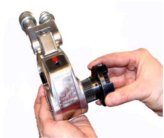
Engager le système d'entraînement dans la clé AVANTI
