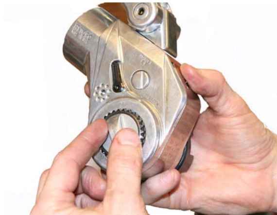
Visser la partie interne du clip jusqu'il soit engager complètement dans la clé AVANTI; Il ne doit pas dépasser de la clé.
