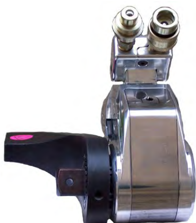
Clé en position de desserrage
