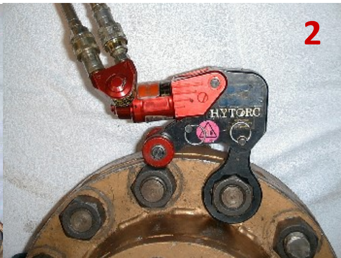
Position de la clé en fin de cycle (Piston complètement avancé)
