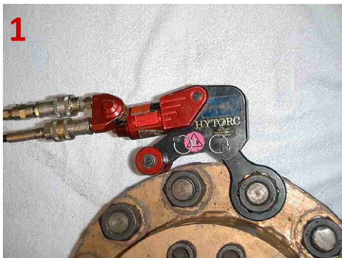
Positionnement de la clé pour débuter le cycle de serrage. ( piston complètement rétracté)
