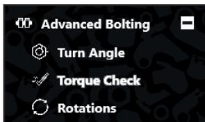
Vous retrouvez ici les sous-menus Turn Angle (serrage uniquement à l'angle), Torque Check (vérification du couple de serrage), et Rotations, qui correspond au nombre de tour du carré lors d'un serrage. Ces sous-menus vous servent uniquement en cas de serrage ponctuels.
